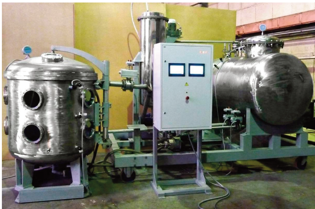
Рис. 4. Опытный образец бароаквариума для контроля герметичности ДСЕ РКТ
