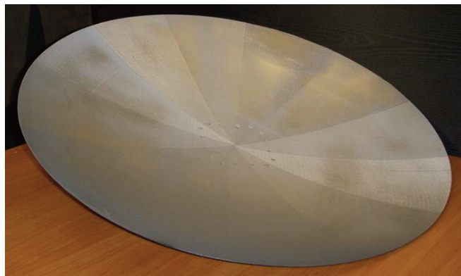
Рис. 8. Рефлектор антенного устройства с нанесённым радиоотражающим покрытием
