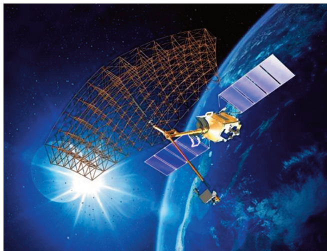
Рис. 2. КА «Кондор» с трубчатой конструкцией каркасов антенн
